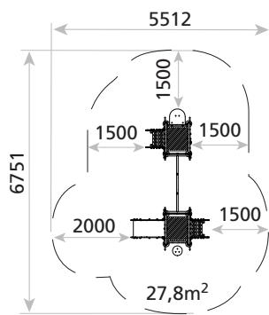
Instalación | Installation | Installation
